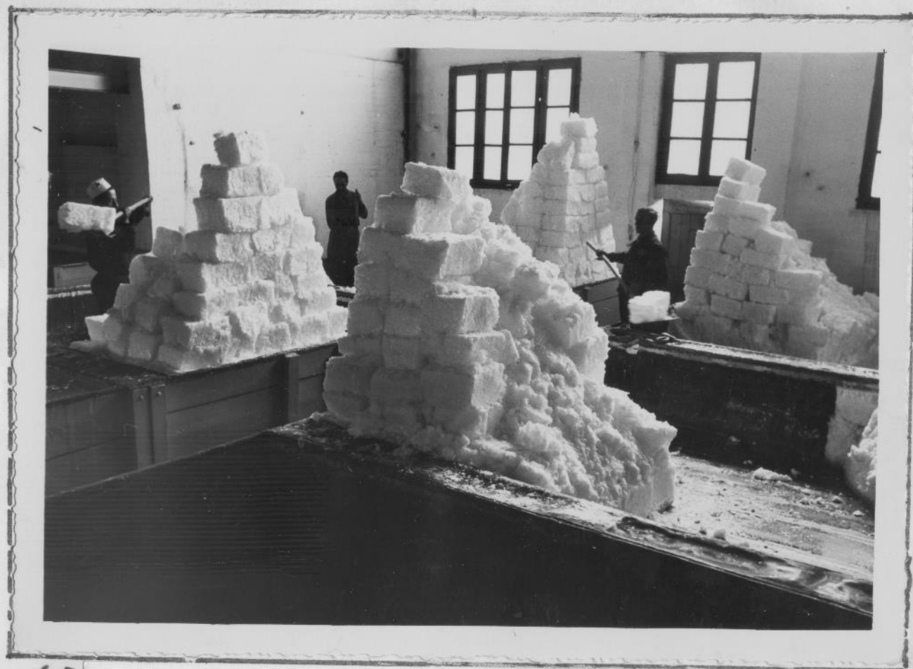
80-82-83- Larderello :Raffineria acido borico. Tini di reazione e sale cristallizzanti acido borico gristallo e paglietta. (Dal 1910 al 1956)
